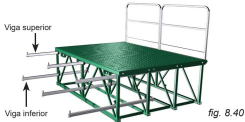
La configuración de viga ilustrada en la fig. 8.40 necesita vigas adicionales que no se suministran de fábrica con las unidades y los puentes de la serie M2.
